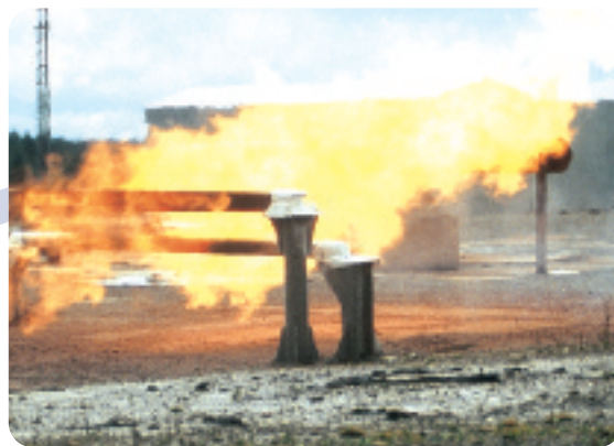
Испытание на стойкость к реактивному пламени по BG Technology's Spadeadam.
